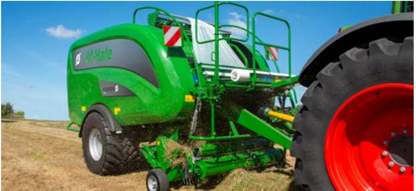
El nuevo canal de alimentación cónico favorece que el forraje fluya desde el pick-up hacia el rotor y la cámara de empaçado, maximizando el rendimiento. Mchale también ha desplazado hacia delante los sinfines de alimentación laterales y sus extremos están inclinados hacia el rotor para mejorar el flujo del forraje.
