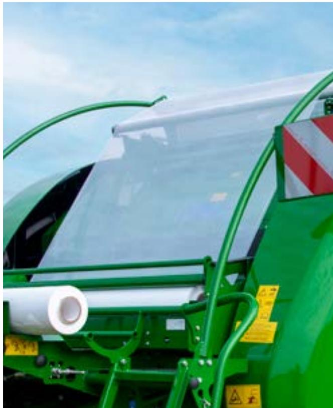
Se han **DISEÑADO Y DESARROLLADO** dos sistemas de encintado de alto rendimiento para garantizar un rendimiento óptimo. La McHale Fusion 4 y Fusion 4 Pro están equipadas con un sistema de malla elástica de pivote, mientras que todas las máquinas Fusion 4 Plus están equipadas con un sistema de unión hidráulica de estiramiento infinito. Estas unidades de encintado son extremadamente fiables y cuentan con:
