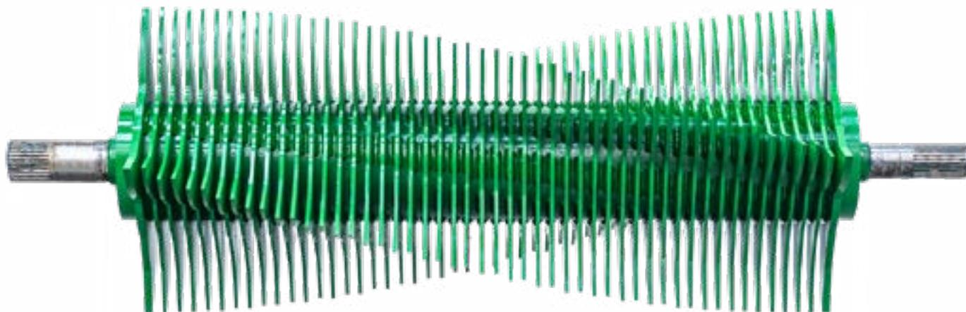
El rotor con forma de estrella asegura un **FLUJO ALTO** de material hacia la cámara de empacado.
